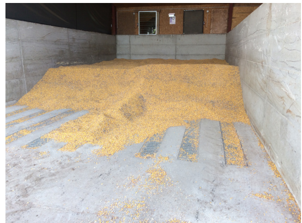
Exemple de valorisation de la chaleur : séchoir en vrac
